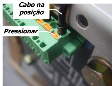
FIGURA 3.1 - CONEXÃO DOS CABOS
