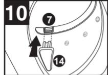
Encaixe o Acabamento do Seletor de Temperaturas (14) na Chave Seletora de Temperaturas (7), mantendo a mesma na posição (0) desligada.
