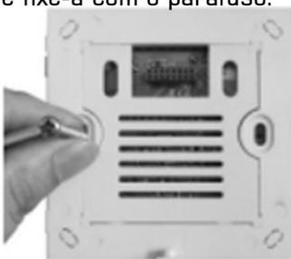
4) Ajustar o parafuso e encaixe o painel.
