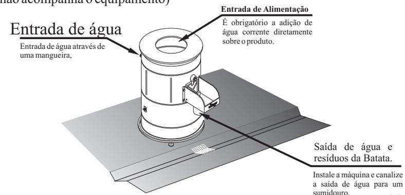
O jato de água que entra no equipamento não devera ultrapassar o centro do disco conforme indicado no Desenho-01.
