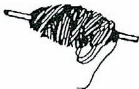
**LINHA ou CORDEL** - Necessária para a demarcação das valas de fundação no terreno e das paredes sobre os alicerces. Serve ainda para orientar a colocação na horizontal das fiadas - quando são esticadas entre pregos ou pinos ou presas em peças não assentadas. Podem ser empregados fios de náilon ou metálicos.
