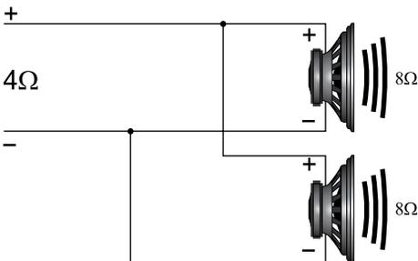
Cálculo de Ligação em Paralelo - O inverso da soma dos inversos das impedâncias dos alto-falantes ligados em paralelo resulta a Impedância total do circuito.
