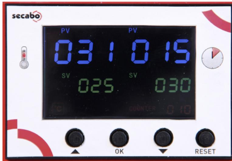
El controlador central permite manipular a temperatura desejada (° C ou ° F) e a pressãodo tempo em segundos. Os dígitos verdes representam os valores nominais, em quanto os números brancos refletem os valores reais. Na parte inferior direita da telaindica-se o número de prensados realizados desde a última posta em zero.
