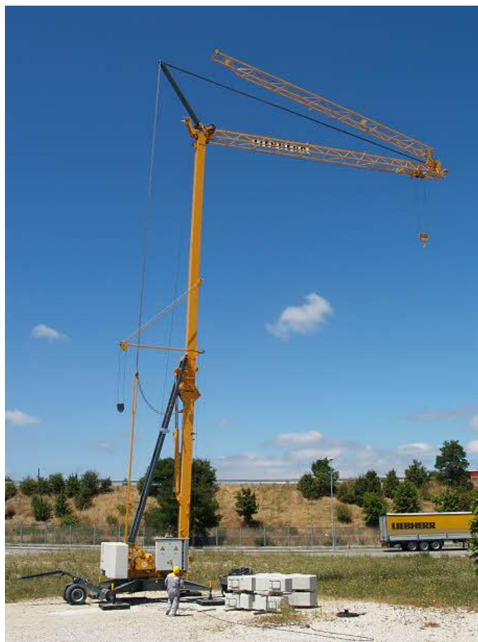
Figura 25: Grua torre de montagem/desmontagem automática (Liebherr, 2012)
