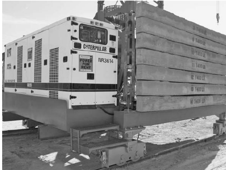
Figura 29: Base móvel de uma grua torre (Shapiro, et al., 2011)
