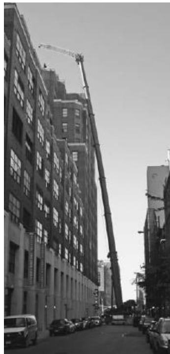
Figura 46: Grua móvel de lança telescópica com lança extensível – fly jib (Shapiro, et al., 2011)
