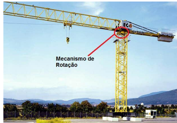
Figura 18: Grua torre do tipo "flat-top" com mecanismo de rotação superior (Liebherr, 2012)
