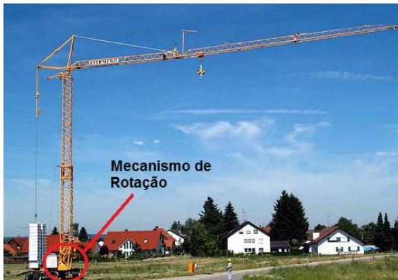
Figura 17: Grua torre com mecanismo de rotação inferior (Liebherr, 2012)
