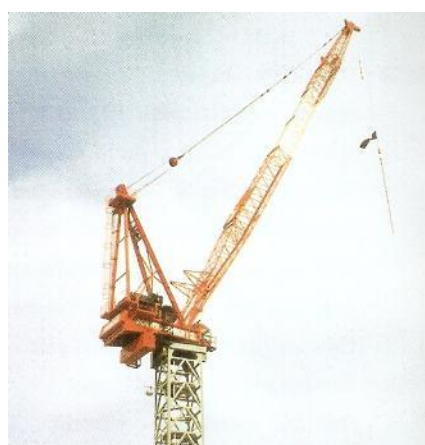
Figura 13: Grua Torre de lança inclinável - Austrália 1989 (Bachmann, et al., 1997)
