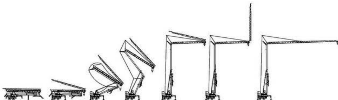
Figura 24: Grua torre de montagem/desmontagem automática (Mantis, 2012)
