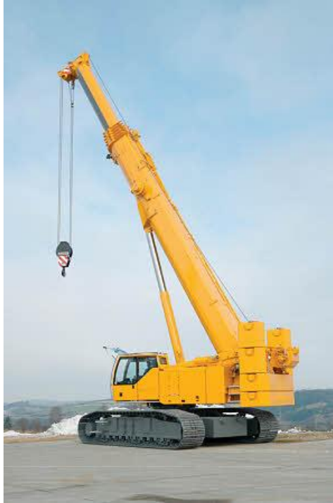
Figura 41: Grua móvel com base de esteiras e lança telescópica (Liebherr, 2012)
