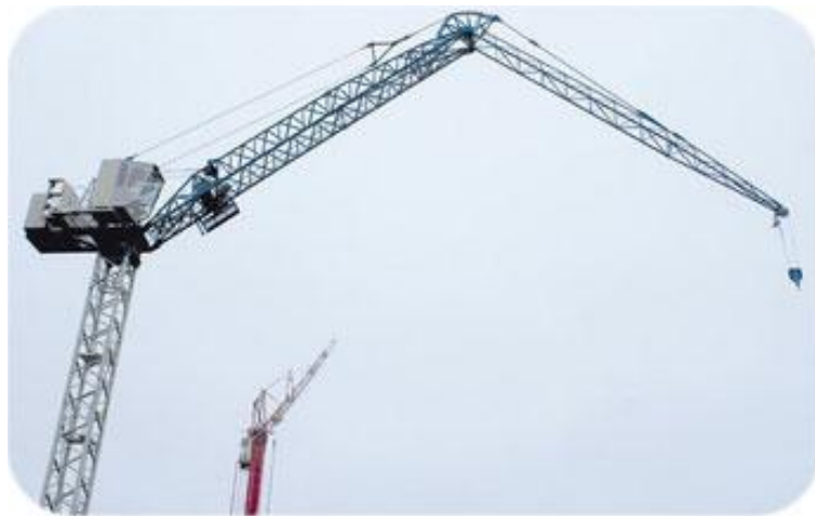
Figura 22: Grua de torre de lança inclinável (Citylifting, 2012)
