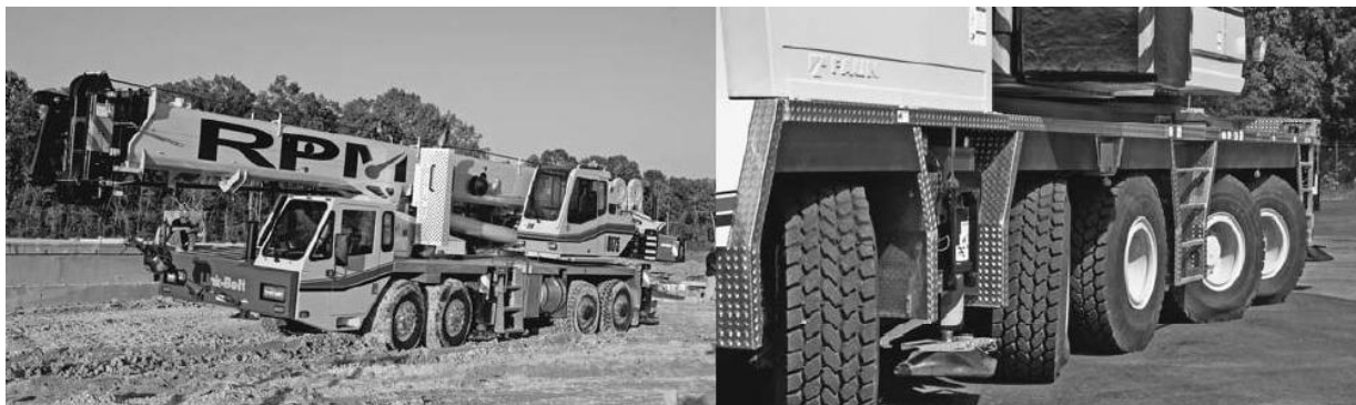
Figura 42: Grua móvel sobre camião de pneus do tipo todo-o-terreno (Shapiro, et al., 2011)
