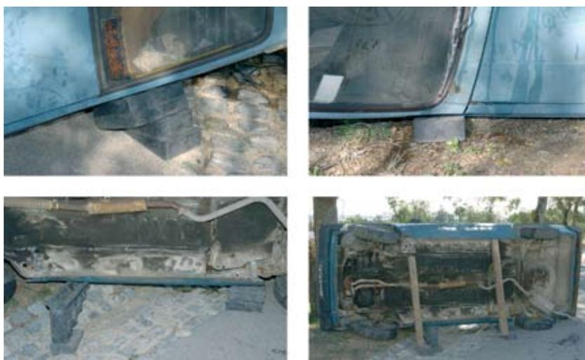
Fig. 57 Estabilização do veículo tombado lateralmente.
