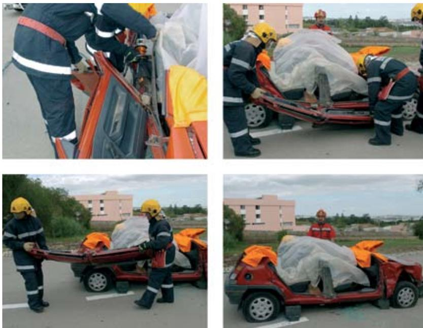
Fig. 90 Corte do pilar B e remoção da lateral.
