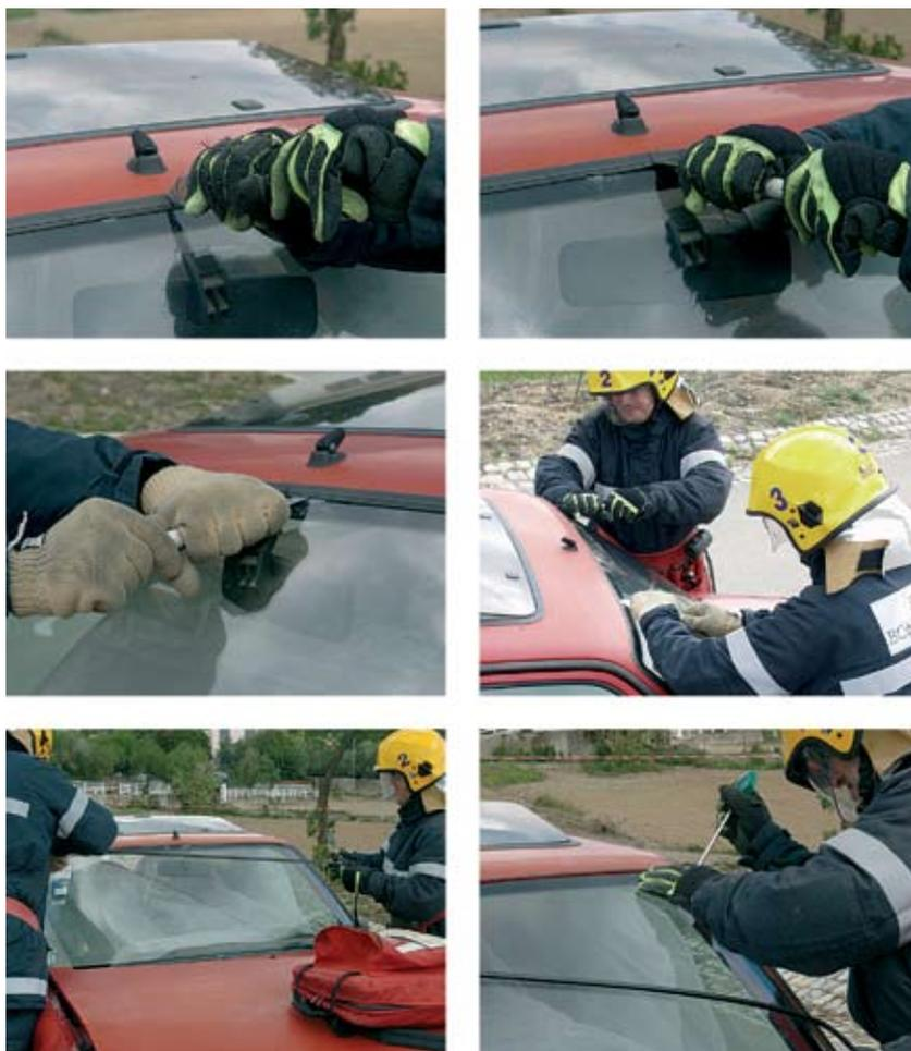
Fig. 48 Remoção de vidros montados com borrachas.
