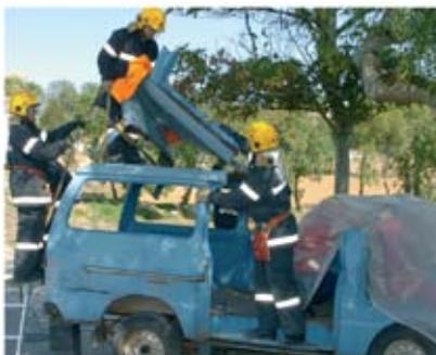
Fig. 101 Remoção parcial do tejadilho à rectaguarda.
