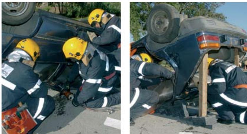
Fig. 94 Corte de pilares.
