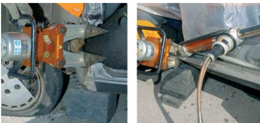
Fig. 81 Estabilização da base de apoio.
