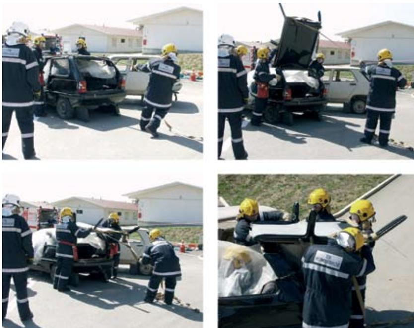
Fig. 67 Levantamento do tejadilho para a retaguarda.
