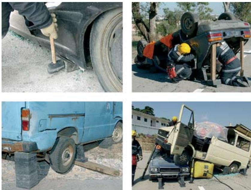
Fig. 54 A estabilização do veículo evita movimentações desnecessárias.
