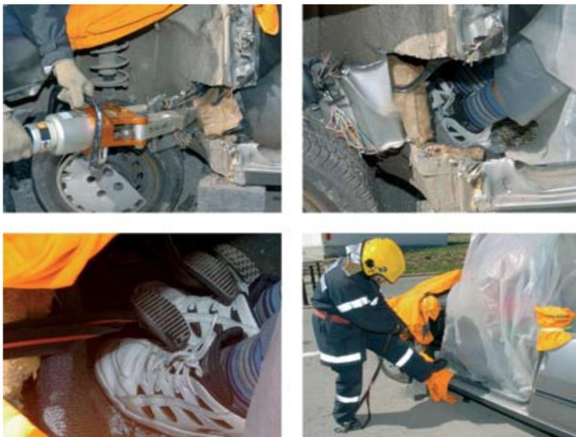
Fig. 86 Abertura do painel lateral, visualização dos membros inferiores da vítima e afastamento dos pedais.
