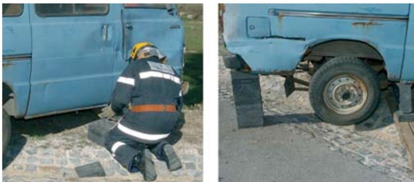
Fig. 98 Estabilizar o veículo no mínimo em quatro pontos.
