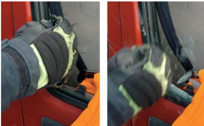
Fig. 50 Remoção de vidro da porta.
