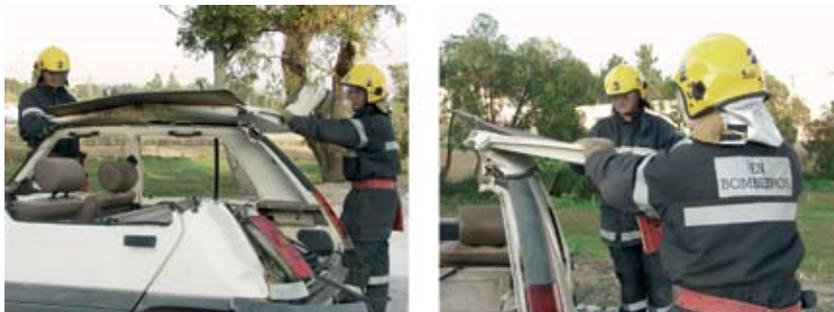
Fig. 74 Levantamento lateral do tejadilho.
