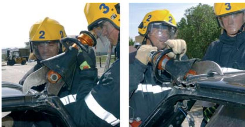
Fig. 65 Cortes parciais no tejadilho junto aos pilares C.
