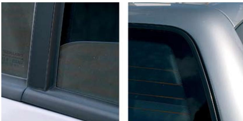
Fig. 47 Vidros fixos com uma tira de borracha.
