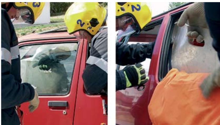
Fig. 51 Colocação de protecção para remoção do vidro.
