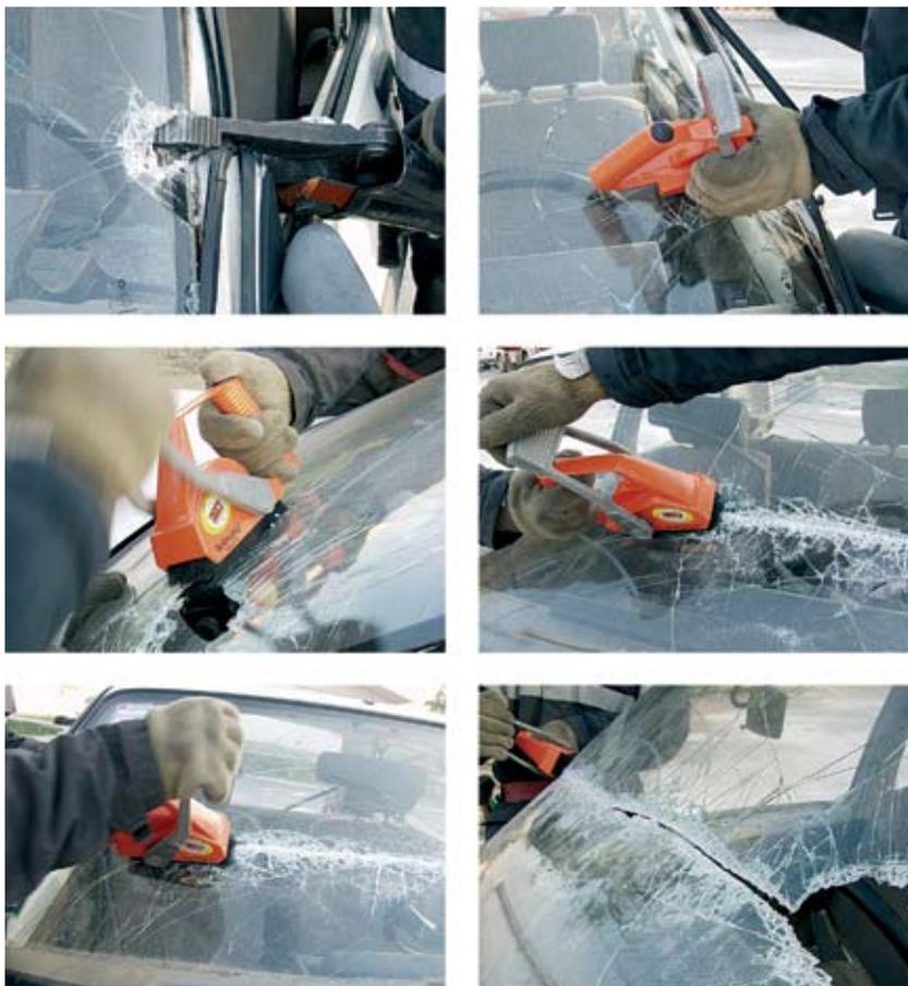
Fig. 49 Remoção de vidro laminado.
