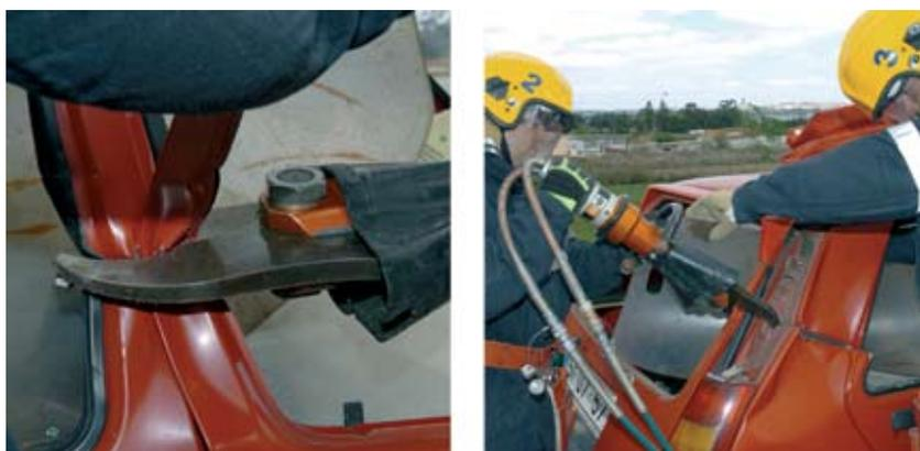
Fig. 68 Corte dos pilares B e C de ambos dos lados do veículo.
