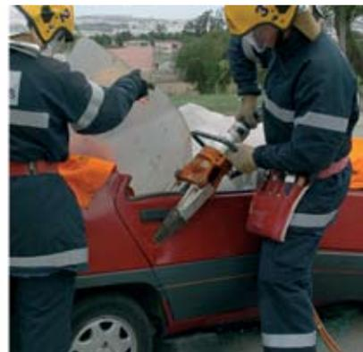
Fig. 89 Abertura forçada das portas.
