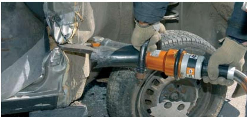
Fig. 80 Corte total do pilar A.
