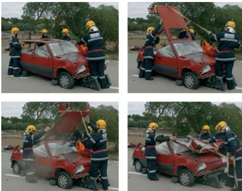
Fig. 70 Levantamento do tejadilho para a frente.
