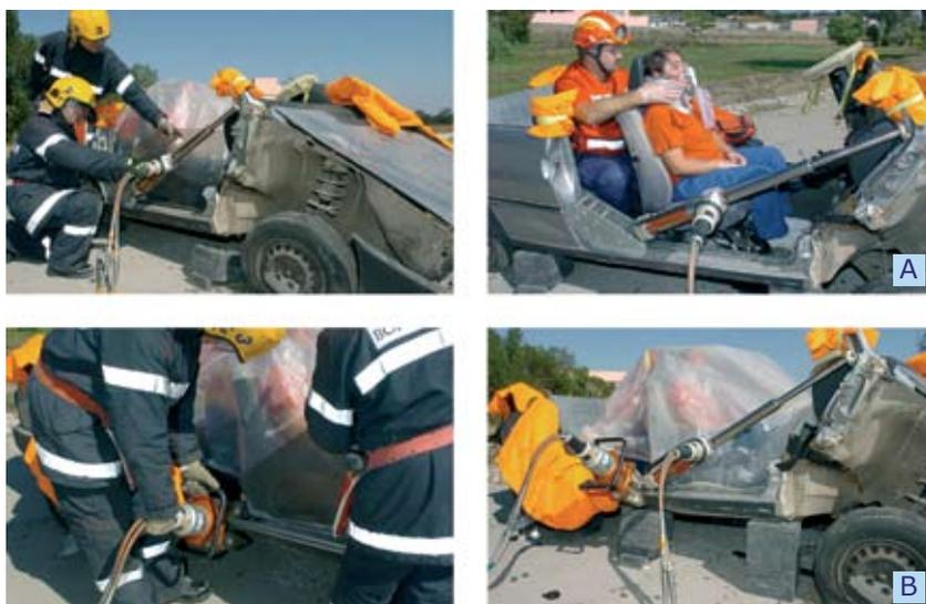
Fig. 83 Afastamento do tablier com o extensor. A - Utilizando como base de apoio o suporte do extensor; B - Utilizando como base de apoio o expansor.
