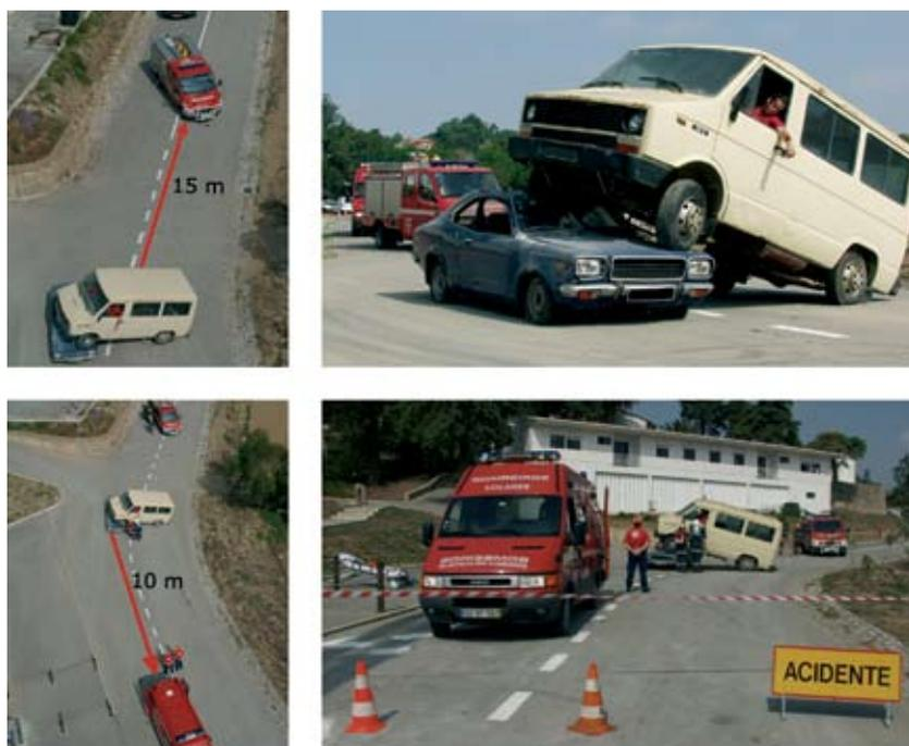
Fig. 4 Posicionamento defensivo dos veículos de socorro.
