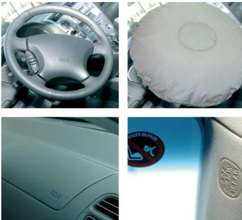
Fig. 52 Exemplos de locais onde estão instalados *airbags*.
