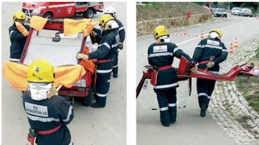
Fig. 76 Remoção do tejadilho para o depósito de destroços.
