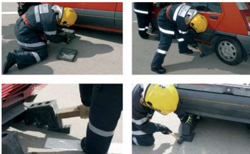
Fig. 56 Estabilização do veículo em posição normal.
