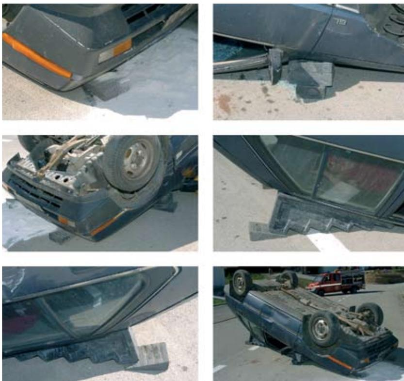
Fig. 58 Estabilização do veículo capotado.
