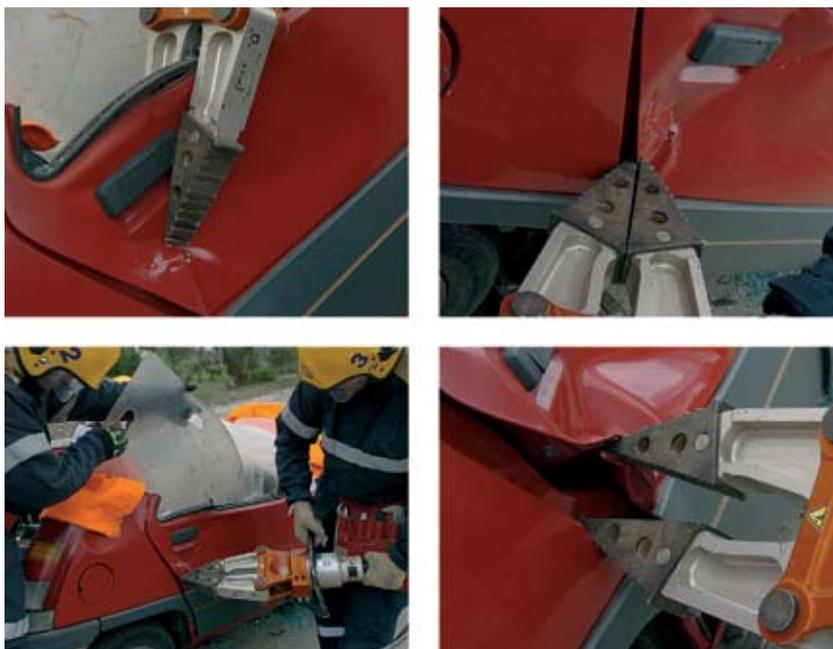
Fig. 78 Abertura forçada da porta pela fechadura.
