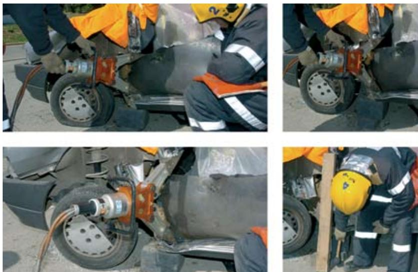
Fig. 82 Afastamento do tablier com o expansor.
