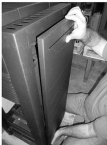
Figura 7 – Montagem das capas laterais
