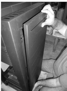
Figura 19 – remoção das capas laterais
