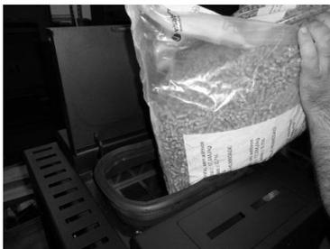
Figura 21 – Reabastecimento do depósito de pellets
