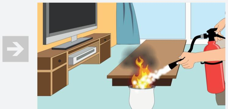
Posicione-se a uma distância segura do foco. Se estiver ventando, coloque-se de uma forma que o fogo não venha na sua direção.
