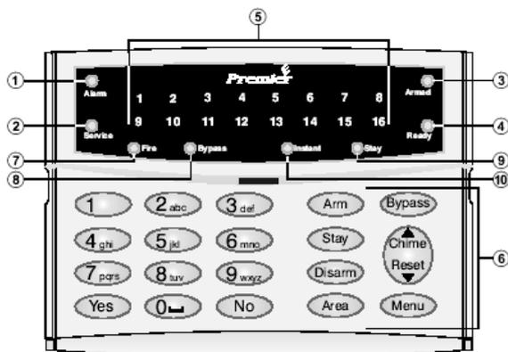
**1 – ALARM:** Sempre que o sistema tenha gerado um alarme o Led vermelho “ALARM” aparece aceso, o sistema não pode ser armado sem que o alarme tenha sido reconhecido.
