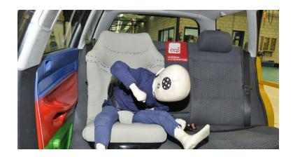
O manequim de 3 anos termina a sua trajetória na posição demonstrada na figura. O Sistema de Retenção permanece fixo no assento do veículo após o embate e o arnês permanece apertado na respetiva fivela. Fundamentado nos dados obtidos e nos critérios avaliados neste ensaio, a probabilidade de ferimentos graves do passageiro depois do impacto é extremamente alta.
