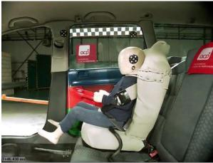
Manequim posicionado nos assentos traseiros antes do impacto. O teste representa um choque frontal de 2 veículos a 64km/h com uma sobreposição de 40% por o lado do condutor.
