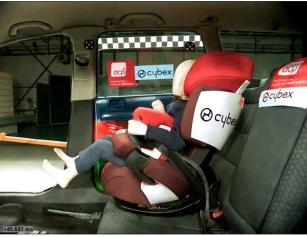
impacto. O teste representa um choque frontal entre 2 carros a uma velocidade de 64km/h com sobreposição de 40% no lado do condutor.
