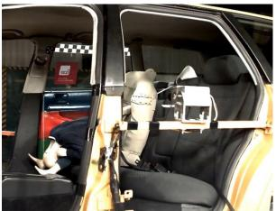
Aos 137 milésimos de segundos, a cabeça entra em contato com a parte inferior do assento, os sensores situados no interior da cabeça do manequim chegam a medir um valor de 185g sendo o risco para o ocupante de sofrer ferimentos graves é muito alto. Num impacto de veículo real com todos os componentes do carro, é muito provável que a criança embata contra partes do veículo com graves consequências para o passageiro.
