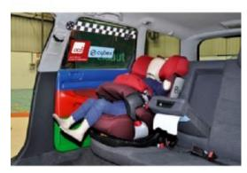
O manequim de 3 anos termina a sua trajetória posicionado no sistema de retenção, que permanece instalado no veículo após o impacto. Tendo em conta os dados obtidos e os critérios avaliados a probabilidade de sobrevivência do passageiro ao impacto é alta.
