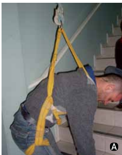
Figura 5 – Trabalhador vestindo a amostra 1. a) posição de detenção de queda; b) ajuste da fita secundária. Fonte: Autores, 2011
