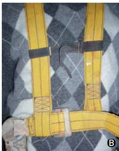
Figura 5 – Trabalhador vestindo a amostra 1. a) posição de detenção de queda; b) ajuste da fita secundária. Fonte: Autores, 2011
