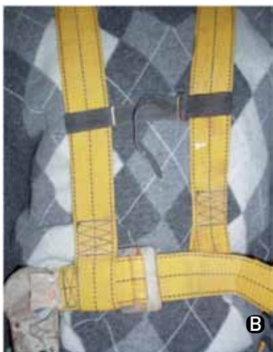
Figura 7 – Trabalhador vestindo a amostra 3: a) posição de detenção de queda; b) ajuste da fita secundária. Fonte: Autores, 2011
