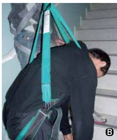
Figura 6 – Trabalhador vestindo a Amostra 2: a) fivela de ajuste da perna; b) posição de detenção de queda. Fonte: Autores, 2011
