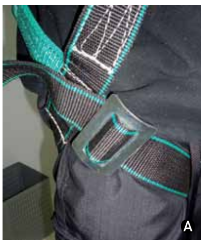
Figura 6 – Trabalhador vestindo a Amostra 2: a) fivela de ajuste da perna; b) posição de detenção de queda. Fonte: Autores, 2011
