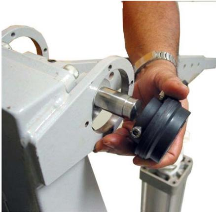
Figura 1.18 - Colocação do Ímã no Eixo
