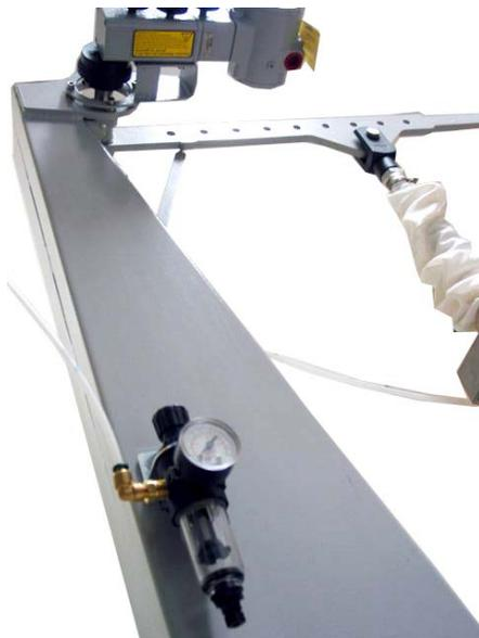
**Figura 1.30 - Instalação do Filtro de Ar**
