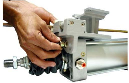
**Figura 5.8 – Soltando os Parafusos Allen**
