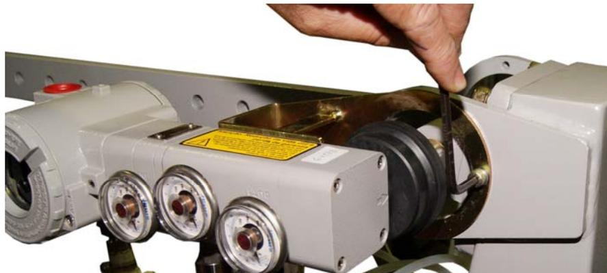
Figura 1.22 - Montagem do Conjunto "posicionador + suporte" na Base
