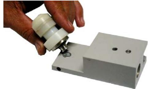
**Figura 5.14 – Desmontagem do Rolete Móvel**
