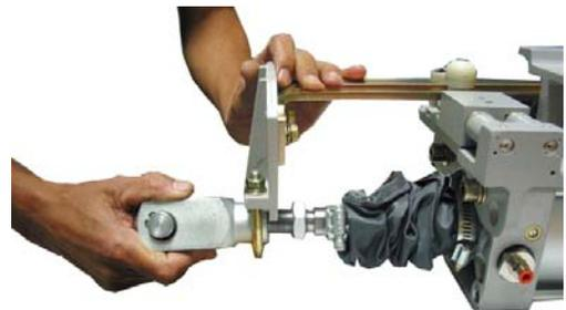
**Figura 5.6 – Tirando a Ponteira do Eixo do Cilindro**
