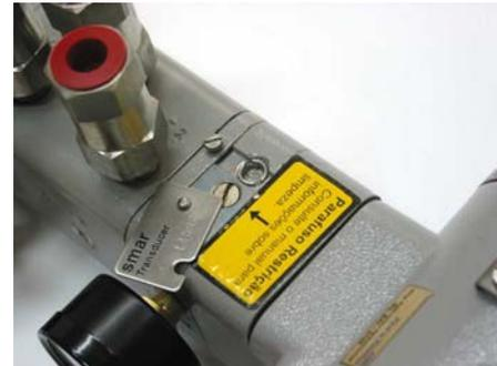
**Figura 5.22 – Placa de Proteção da Restrição retirada**
