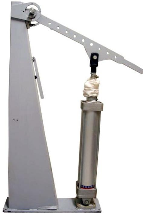
**Figura 1.15 - Base do ACP Rotativo montada com o Cilindro**
