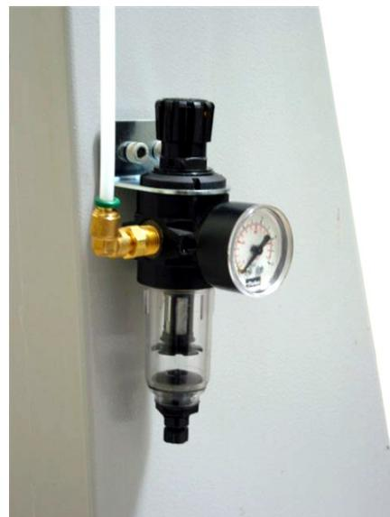
**Figura 1.31 - Detalhe do Filtro de Ar**
