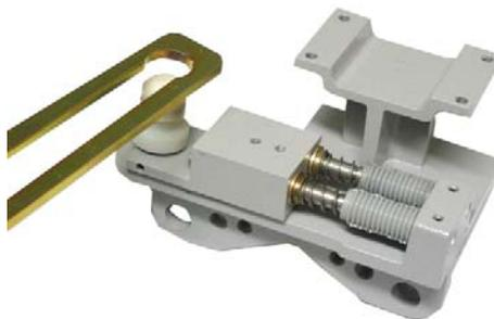
**Figura 5.10 – Desmontagem da Régua**
