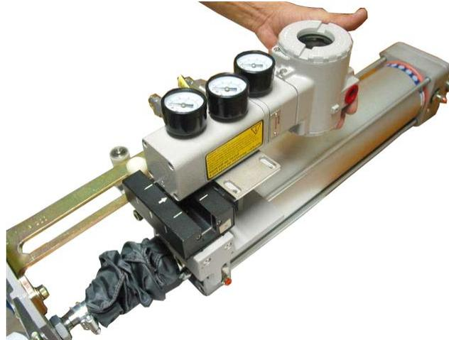
**Figura 5.2 – Desmontagem do Posicionador do ACP do Cilindro**
