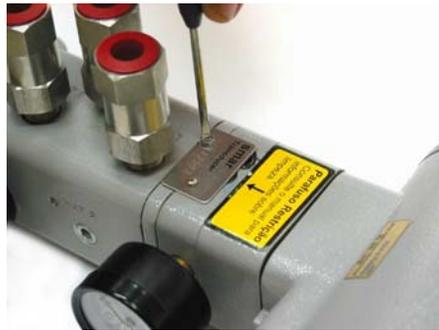
**Figura 5.21 – Removendo a placa que protege a Restrição**
