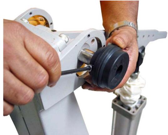
Figura 1.19 - Detalhe da Fixação do Parafuso (não apertar)
