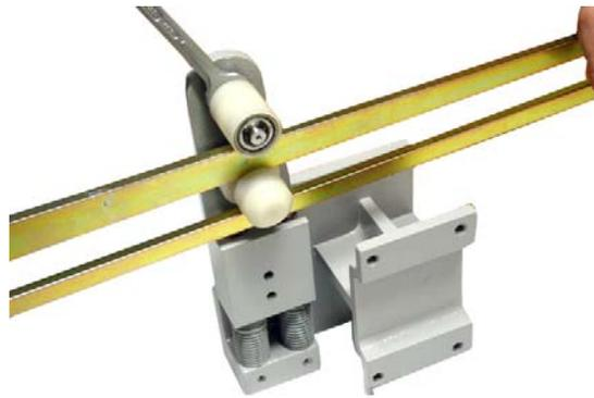
**Figura 5.9 – Desmontagem do Rolete Fixo**
