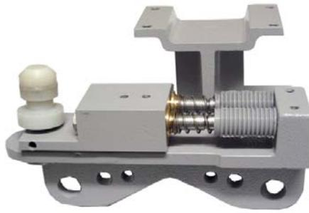
**Figura 5.11 – Subconjunto da Base Móvel antes de ser desmontado**
