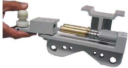
**Figura 5.12 – Desmontando o Subconjunto da Base Móvel**
