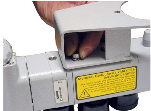
Figura 1.21 - Montagem do Suporte no Posicionador
