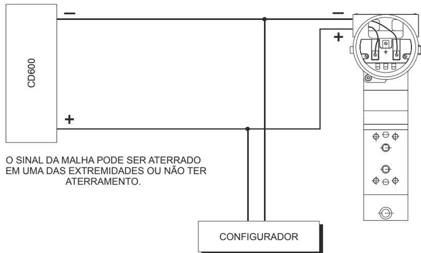
**Figura 1.38 - Diagrama de Ligação do Posicionador**
