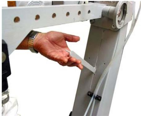
**Figura 1.24 - Detalhe da Alavanca Auxiliar de Posicionamento**
