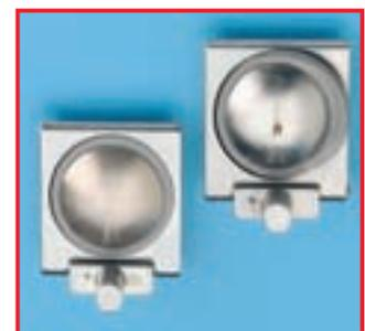
Direita: Válvula de palheta mal vedada de um trocarte devido ao inchaço da vedação, em consequência do contato com óleo.
