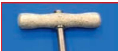
Ataque do material no cabo de alumínio Causa: Limpador alcalino inadequado
