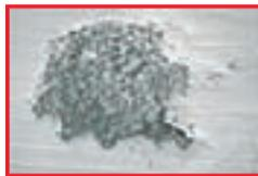
Corrosão localizada - visto sob um microscópio eletrônico de varredura - ampliação de 200x
