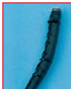
Inchaço de uma mangueira condutora, devido à aplicação de conservante inadequado.
