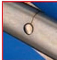
Detalhe: Articulação de trava da tesoura com fissura intercrystalina típica.
