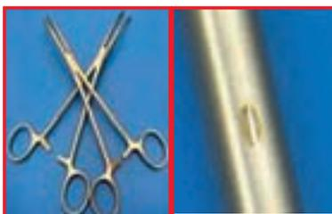
Corrosão por contato: aço inoxidável / aço inoxidável
