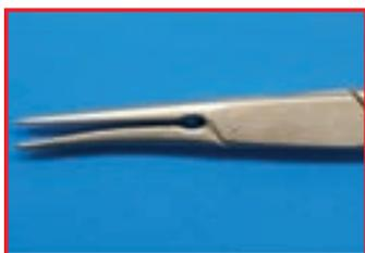
Deformação causada pelo manuseio inadequado
