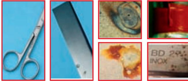
Tesoura com corrosão localizada
