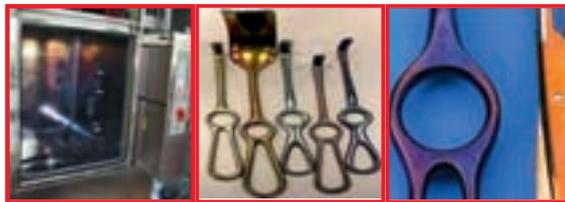
Manchas típicas de silicato na câmara de enxágue e na superfície do instrumento devido a limpadores com silicatos e teor excessivo de ácido silícico na água
