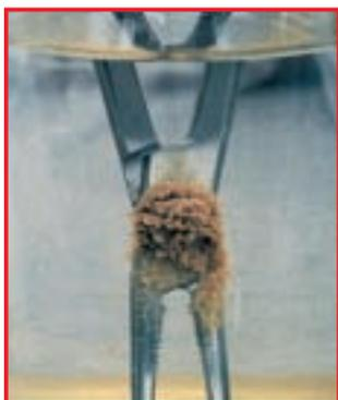
Corrosão causada pela imersão de várias horas em uma solução de soro fisiológico
