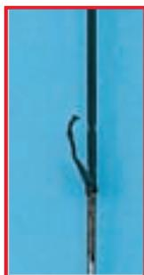
Isolamento danificado em um instrumento de alta frequência
