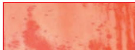
Ataque do material da superfície de alumínio anodizado natural / colorido em contenedores Causa: alto teor inadmissível de solução alcalina de lavagem
