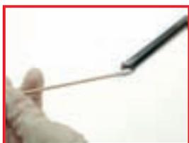
Limpeza de uma lente objetiva do endoscópio
