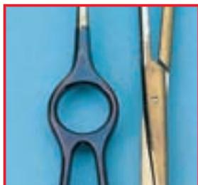
Instrumentos descoloridos por ácido silícico
