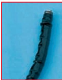
Inchaço na extremidade distal de um fibroscópio
