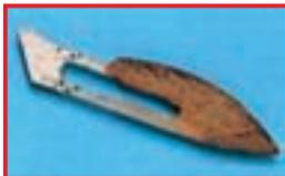
Ataque ao material superficial da lâmina devido à umidade. Causa: Composição do material, aço normal, por se tratar de produto descartável.
