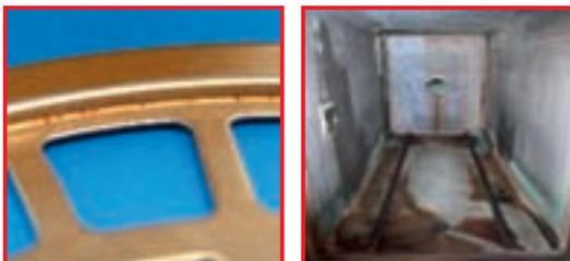
Esquerda: suporte do filtro com ataque corrosivo por partículas
