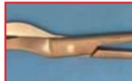
Decapagem da superfície do instrumento. Causa: Ataque ácido devido ao excesso de dosagem.
