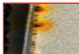
Decapagem das costuras de solda. Para tesouras, pinças e porta-agulhas de carboneto de tungstênio Causa: Ataque ácido devido ao excesso de dosagem de neutralizadores químicos ou à aplicação de produtos de limpeza básica.
