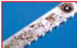
Ataque de material à camada de cromo parcialmente defeituosa. Causa: A umidade leva à corrosão do material de suporte desprotegido, feito em aço normal
