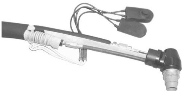
3. Substituir o isolamento como se mostra na imagem. Substituir os interruptores no conjunto. Avançar para o passo 6.
