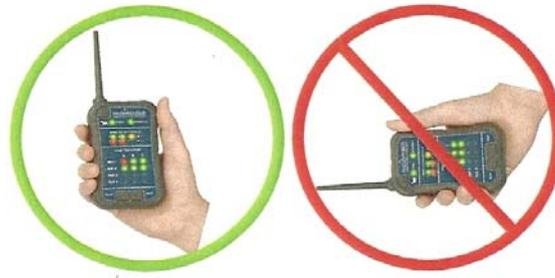
Figura 4 Posicione o Leitor Remoto de Faltas da forma mostrada à esquerda
