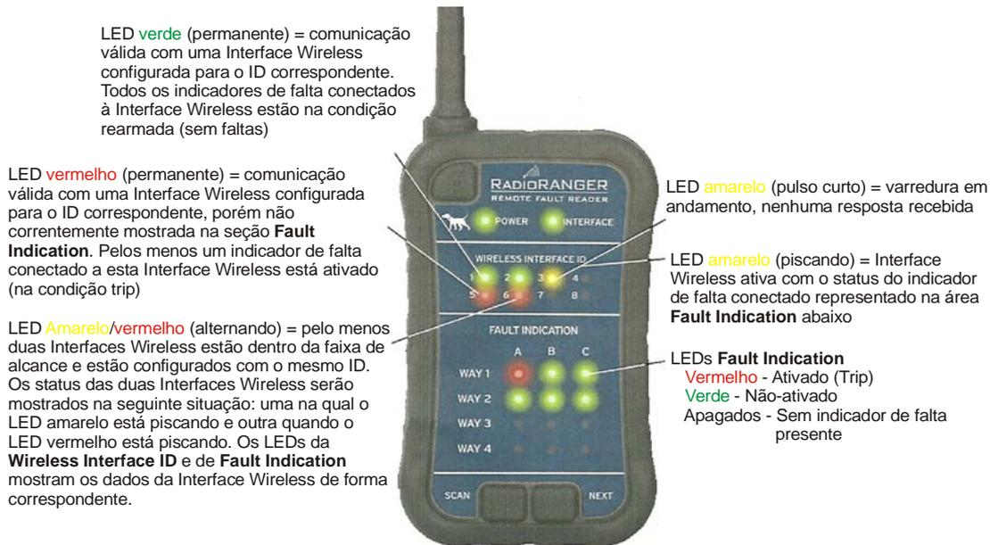
Figura 10 Interpretando os LEDs das áreas Wireless Interface ID e Fault Indication
