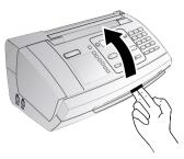
Encaixe completamente a tampa do aparelho quando o abrir. Pode sofrer lesões, caso a tampa caia quando estiver a executar trabalhos no aparelho.
