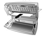
4 Rode a roda dentada azul para a frente para tensionar a película de tinta. A película de tinta não se pode enrugar.
