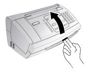
Encaixe completamente a tampa do aparelho quando o abrir. Pode sofrer lesões, caso a tampa caia quando estiver a executar trabalhos no aparelho.
