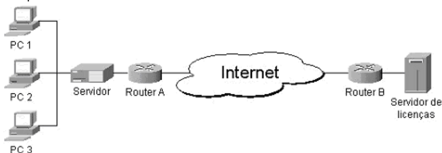
Figura 3. Exemplo de uma WAN em que o servidor de licenças é um equipamento remoto.
