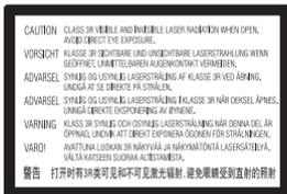
Esta etiqueta está localizada na caixa de proteção do laser no interior do aparelho.
