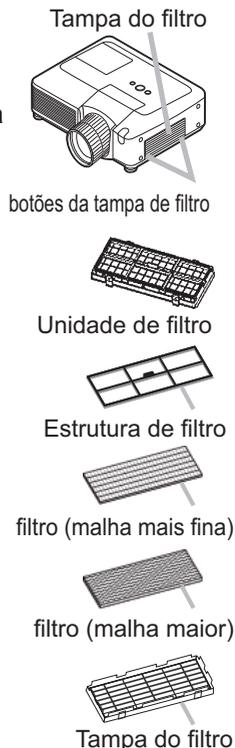
**⚠ AVISO ►** Antes de cuidar do filtro de ar, certifique-se de que o cabo de alimentação não está ligado, e depois deixe o projector arrefecer o suficiente.
