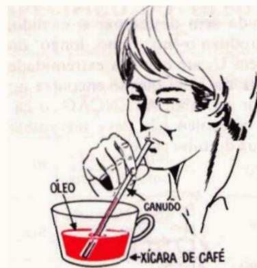
**6** Quando o óleo atingir metade da altura do canudo, tampe imediatamente com o dedo sua extremidade superior. Em seguida, retire o canudo da xícara.
