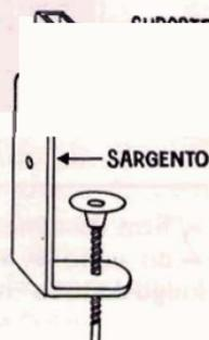
**2** Fixe o sargento na beirada de uma mesa, girando o parafuso.
