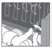
ETAPA 1 Posicione a almofada na cadeira, assegurando-se de que esteja centralizada e com as células de ar para cima, com a válvula de ar voltada para frente, no canto esquerdo (onde o usuário está sentado). Consulte seu profissional de saúde sobre as posições alternativas para as válvulas de ar. Gire a válvula no sentido anti-horário para abrir.
