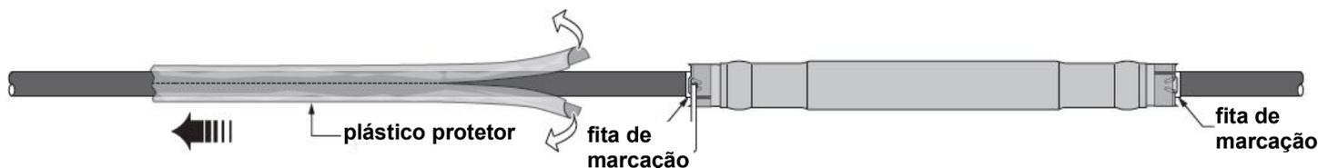
22 – Fixe o conjunto no cabo apertando com firmeza a abraçadeira do cabo. Remova a fita transparente do lado não fixado.
