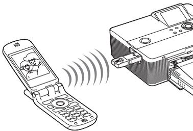
Para seleccionar a impressora a partir de um dispositivo compatível com Bluetooth, seleccione “Sony DPP-FP60 ##”. (“##” corresponde aos dois números a contar da direita no endereço que aparece no LCD.):
