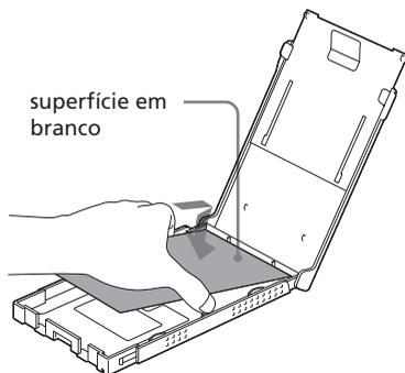
**5** Coloque o tabuleiro de papel na impressora e carregue em **PRINT**. A cartridge de limpeza e a folha de limpeza limpam o interior da impressora. Terminada a limpeza, a folha de limpeza é automaticamente ejectada.
