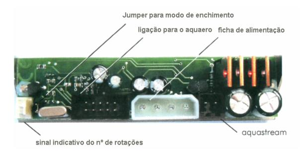
Desligue em primeiro lugar o seu computador e desligue a fonte de alimentação por completo por meio do interruptor traseiro. Remova todos os cabos de alimentação (por exemplo do disco rígido, leitores de CD-ROM/DVD/ROM, placas gráficas, etc..). Ligue o controlador de 3 ½" da aquastream a uma ficha de alimentação da sua fonte de alimentação e insira o cabo de alimentação da aquastream no seu sítio correspondente no controlador da aquastream.
