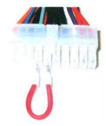
Para ligar a fonte de alimentação independentemente da motherboard, remova o conector ATX da fonte de alimentação da motherboard. Insira agora um dos lados do cabo fornecido na embalagem no buraco da ficha ATX correspondente ao fio verde e o outro lado do cabo num buraco qualquer de cor preta (correspondente à massa). Feita esta ligação poderá ligar a fonte de alimentação.
