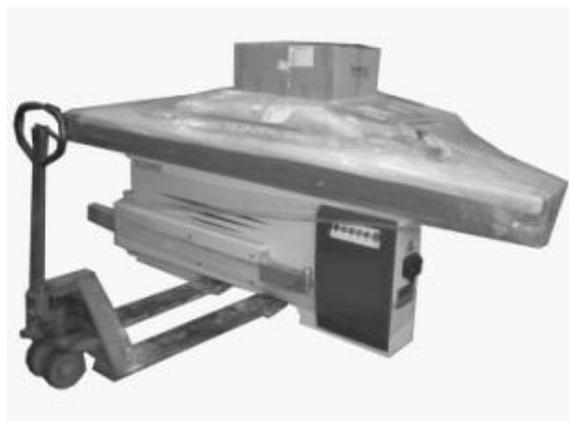
Posicione a máquina de acordo com seu espaço, lembrando-se de deixar livre o espaço para correr a guia da mesa móvel, bem como fazer a devida movimentação com as peças a serem cortadas.
