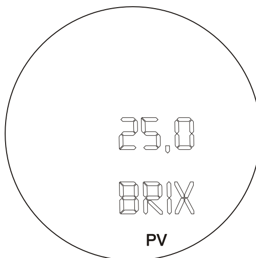
Figura 2.5 – Modo de Monitoração Típico mostrando no Indicador a PV, neste caso 25,0 BRIX
