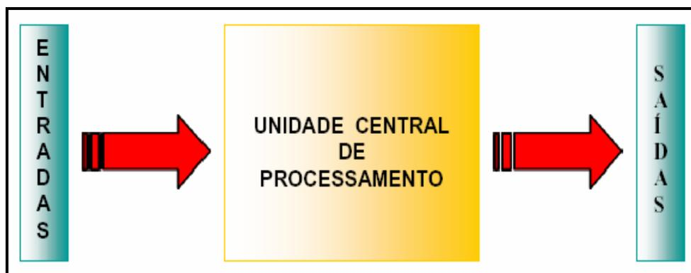
Figura 1.3 - Estrutura básica de funcionamento de um CLP.
