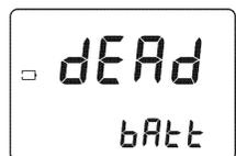
**Dead battery:** Significa que a pilha acabou e deve ser substituída. Quando aparece esta indicação, o medidor bloqueia. Substitua a pilha e ligue o medidor novamente.
