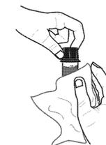
· Agitar a cuvete pode causar bolhas de ar na amostra, originando leituras elevadas. Para obter medições precisas, tem de remover as bolhas de ar agitando circularmente ou batendo cuidadosamente na cuvete.
