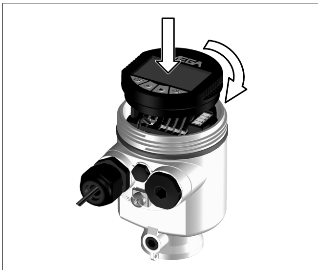
Fig. 19: Colocar o módulo de visualização e configuração
