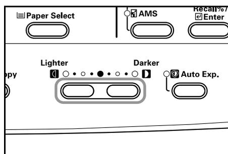
A Exposição de cópia (densidade) é regulada manualmente. Para escurecer a cópia, prima a tecla Exposure Adjustment (Ajuste da exposição) no lado direito e desloque a escala de exposição para a direita. Para aclarar a cópia, prima a tecla Exposure Adjustment (Ajuste da exposição) no lado esquerdo e desloque a escala de exposição para a esquerda. Premir a tecla [Auto Exposure] detecta a exposição da cópia e regula-a para a definição ideal.
