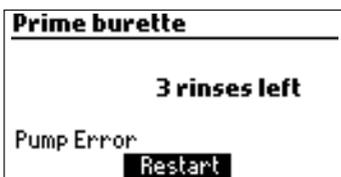
Esta mensagem de erro aparece quando a bomba não está a funcionar correctamente. Verifique a tubagem, válvula e seringa. Pressione **Restart** para voltar a tentar.
