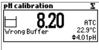
A mensagem "Wrong Buffer" é indicada quando o valor de pH está fora da gama aceitável. Limpe o eléctrodo seguindo o Procedimento de Limpeza e/ou verifique a concentração do padrão antes de continuar com a calibração de pH. Pressione a tecla **ESC** para sair do modo de calibração pH.
