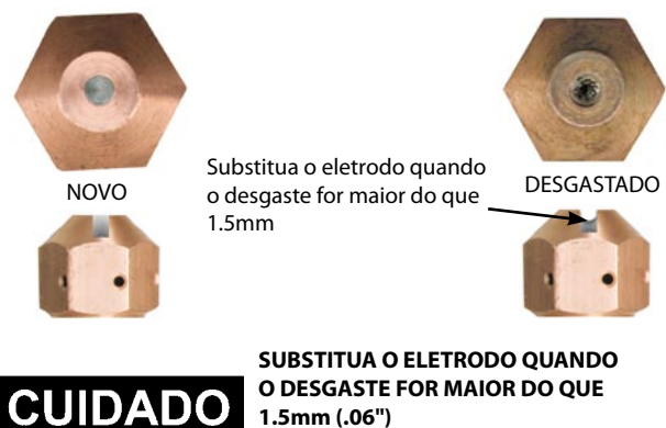
Figura 3-3. Limite de desgaste do eletrodo
