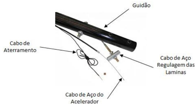
A Figura 1 mostra as partes que deverão ser instaladas para o funcionamento da Alisadora.
