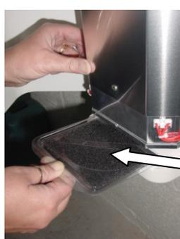
Insira um novo cartucho de filtro, mantendo as pontas do filtro conforme a base; Certifique-se que a rede de retenção fica na diagonal como ilustrado. Empurre o filtro firmemente para a sua posição.
