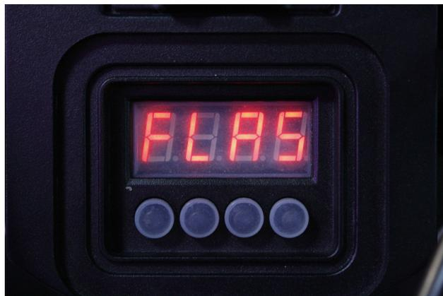
Esse Menu configura o modo Flash, esse é o modo que o equipamento trabalha em Stand Alone, com troca de cores e strobo.
