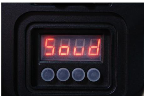
Na configuração Soud >> Tecla SAVE, o aparelho funciona apagado, quando capta um sinal de audio pelo microfone interno ele acende e gera efeitos de strobo e cores de acordo com os beats do audio ambiente.
