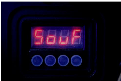
Na configuração SOUF>>tecla SAVE, o aparelho funciona aceso, quando capta um sinal de audio pelo microfone interno, gera efeitos randomicos de cor.
