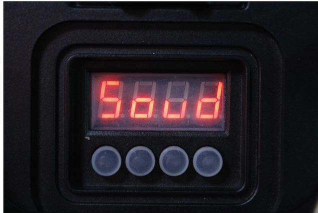
Este menu acima configura o funcionamento de audio, o equipamento funciona no modo automatico de som.
