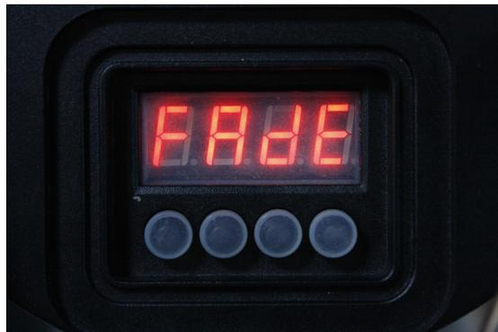
No modo FADE>>Tecla SAVE, o aparelho funciona no modo FADE, nesse modo o aparelho troca de cores randomicamente em fade, com as teclas UP e DOWN, é possível se ajustar entre 13 velocidades, de 00 a 13.
