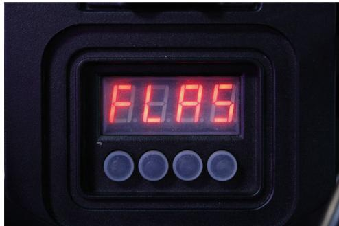
No Modos FLAS>> Tecla SAVE, o aparelho funciona no modo strobo, com as teclas UP e DOWN é possível ajustar entre 13 velocidades, de 00 a 12.
