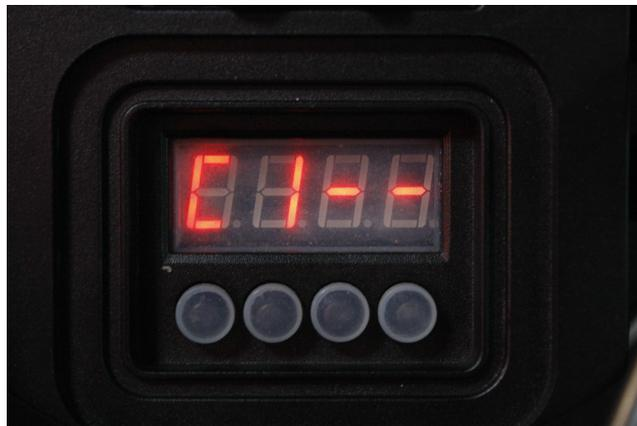
Este Menu acima configura a intensidade de cada cor dos leds para o modo Stand Alone, C1 Red led, C2 Green led, C3 Blue Led, e C4 White led.
