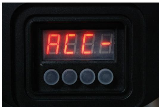
No modo ACC- >>Tecla SAVE, o aparelho funciona no modo Automatic Color Change, troca automatica de cores sem fade, ou seja, troca repentina de cores. Com as teclas UP e DOWN, é possível se ajustar entre 13 velocidades de 00 a 12.
