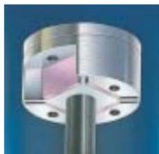
Modelos Inverter DC (direct current) da Daikin são equipados com o motor de Relutância DC (direct current) para compressor. O motor de Relutância DC (direct current) utiliza 2 tipos diferentes de torques, ímãs de Neodímio\*1 e torque de relutância\*2. Esse motor pode economizar energia porque gera mais energia com um uma fonte de elétrica menor do que uma CA ou um motor DC (direct current) convencional.
