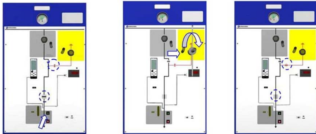
Figura 5.42: Ligação à terra a partir do seccionamento para o mecanismo A(M)V
