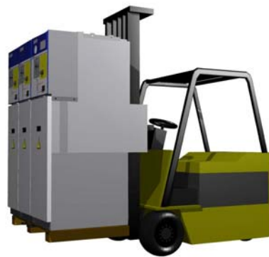
Figura 2.4: Elevação do conjunto de cgm.3 com empilhador
