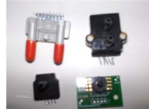
**Figura 10 - Sensores de Fluxo**
