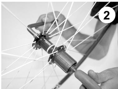
Insira uma chave sextavada de 10mm na extremidade exposta do eixo, e use-a para remover a tampa do eixo.
