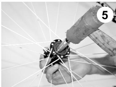
Use um martelo de borracha para bater firmemente o eixo/conjunto de rolamento. Faça o mesmo processo no sentido certo, tocando do lado esquerdo para o direito, com o martelo de borracha. Separe o conjunto.
