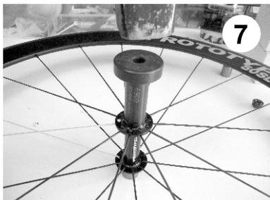
Coloque a ferramenta de serviço de inserção de rolamentos na extremidade aberta. Use um martelo de borracha ou plástico para colocar rolamento no lugar até que esteja totalmente encaixado dentro do cubo.
