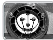
Após remover os parafusos, o pescoço pode ser removido do aparelho.
