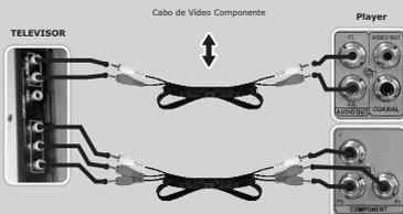
Conectar uma extremidade do cabo Vídeo Componente a entrada **Y Pb Pr** (conexão de vídeo).
