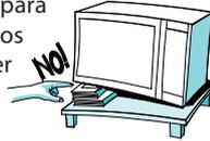
**C**oloque o forno afastado de outras fontes de energia. Para possibilitar ventilação suficiente, deverá haver uma distância de, pelo menos, 30 cm por cima do forno. Certifique-se de que o espaço por baixo, por cima e em redor do forno está vazio, de modo a possibilitar um fluxo de ar adequado. O forno microondas não deve ser colocado dentro de um armário. Este forno não se destina a ser colocado ou utilizado numa superfície de trabalho com distância inferior a 850 mm acima do nível do chão.
