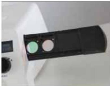
O deslizador de filtros (5) dispõe de 3 posições, das quais as duas primeiras podem ser extraídas e equipadas com os filtros de cor e de conversão adequados para este efeito. A terceira posição é meramente uma posição vazia que não pode ser equipada com um filtro. O deslizador de filtros (5) encaixa ao de leve em sua posição quando esta é alcançada.
