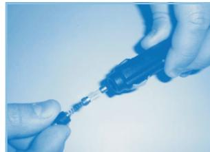
Substitua o fusível ATIVO queimado pelo SOBRESSALENTE, ou se não houver o fusível sobressalente no porta fusível, utilize um fusível correto conforme especificado no tópico "Especificações Técnicas". Antes de utilizar o aparelho novamente, garanta que o porta fusível foi encaixado e fechado corretamente.
