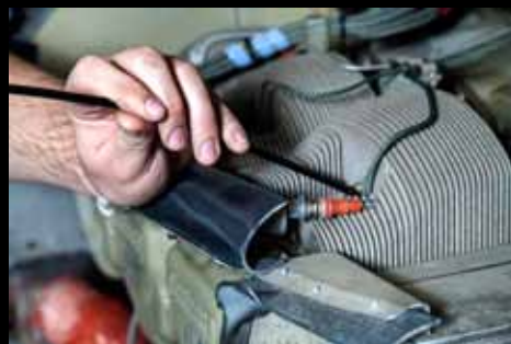
Inspeção do cilindro de motor de aeronave com o VSA2-1M
