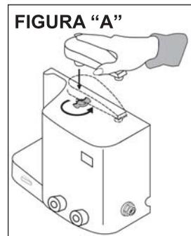
Com leve pressão, encaixe a **Bica/Módulo Retentor de Bactérias** na parte superior do gabinete, com o bico voltado para lateral (FIG. "A"). Após o encaixe, gire a Bica/MRB para frente. Esta operação deve ser realizada antes de fixar o purificador na parede.
