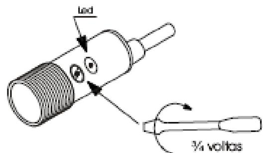
Os sensores capacitivos possuem ajuste de sensibilidade, que devem ser operados com uma chave de fenda adequada.
