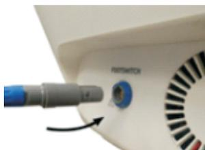
6) Conecte o plug do pedal no conector localizado na parte traseira do equipamento.
