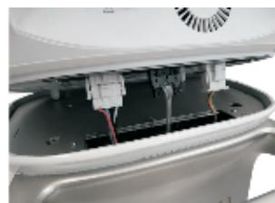
1) Posicione a parte superior sobre a parte inferior de modo que fique ligeiramente inclinada possibilitando o acesso e o manuseio dos conectores da parte inferior, em seguida conecte os três conectores na parte superior e na sequência encaixe a parte superior sobre a parte inferior.
