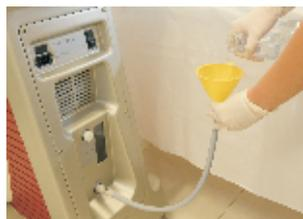
3) Abasteça com aproximadamente 3,5 litros de água desmineralizada observando se o volume não ultrapassa o indicador de nível.
