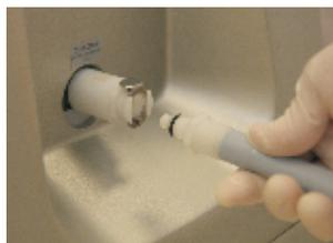
2) Conecte a mangueira do kit funil no conector de entrada/saída do reservatório
