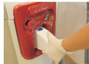
5) O equipamento não deve ser ligado sem a conexão de um aplicador, pois isso irá interromper a circulação de água. Conecte-o.
